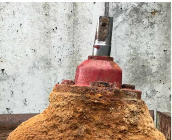
Abb. 1: Gestänge abgerissen, der abgescherte Splint ist noch gut zu sehen.
