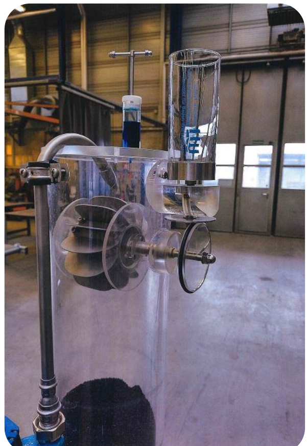
Abbildung 13: Schau- und Versuchsmodell: Filteranlage im Kleinformat, © Zweckverband Landeswasserversorgung
