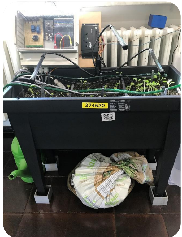
Abbildung 14: Das automatisierte Pflanzenbeet, © Stadtwerke Karlsruhe GmbH
