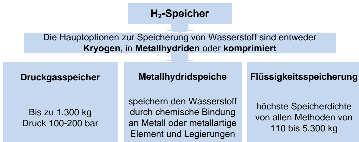
Abbildung 24: Technische Möglichkeiten zur Speicherung von Wasserstoff
